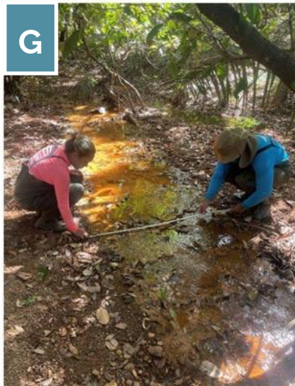
Coleta de amostras e dados nos riachos (A a I), com destaque para a coleta de macroinvertebrados (D e E), perifiton (F) e variáveis físicas e químicas da água (G e H).
